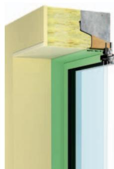
**Isolation thermique par l'extérieur (ITE)**
