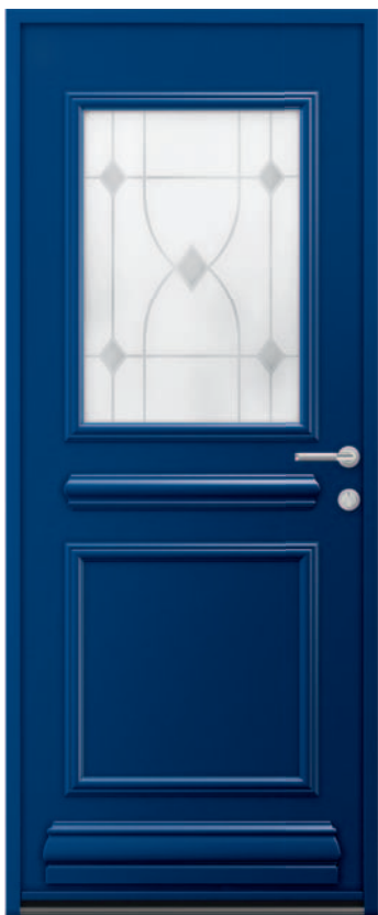
TOPAZE Moulures et cimaises rapportées (côtés int. & ext.) Plinthe rapportée (côté ext.) Triple vitrage feuilleté Motif sablé cristallisé Ud 1,3 W/m 2 .K
