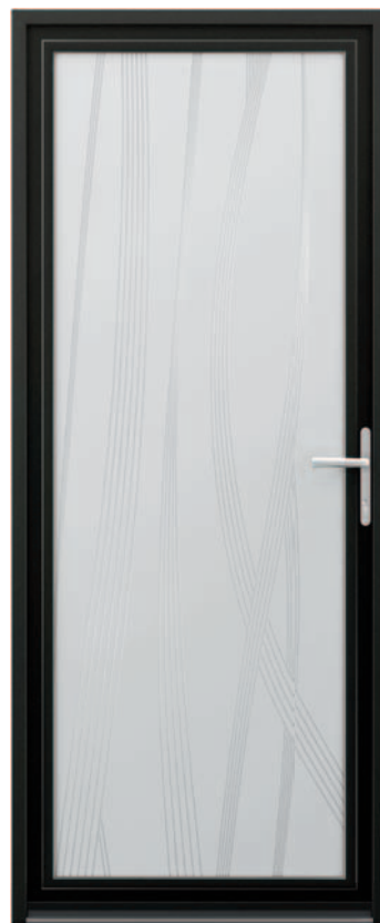
BRISE Ouvrant apparent Triple vitrage feuilleté Motif sablé cristallisé Ud 1,4 W/m 2 .K
